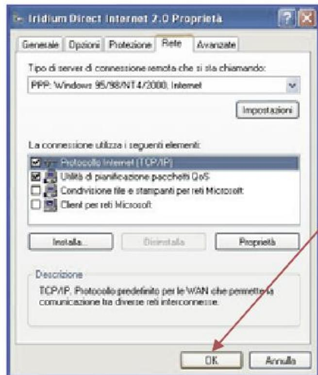
A questo punto il PC/LAPTOP è configurato per effettuare una connessione dial-up con il terminale Iridium 9555.
