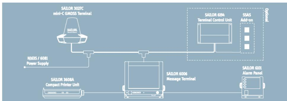
Il nuovo mini-C Sailor 6110 soddisfa i requisiti GMDSS e offre funzionalità per la gestione on board di tutti i servizi LRIT, SSAS, nonché dotato modulo GPS 50 canali predisposto per Galileo. Il nuovo Message Terminal è un'interfaccia touch-screen, stile multimediale che rende user-friendly la gestione delle funzionalità del mini-C
