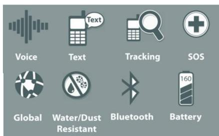
Con un elevato grado di protezione IP65 (resistere agli agenti ambientali, polvere e getti d’acqua) l’IsatpHone 2 dispone di una batteria a lunga durata, fino a 160 ore in stand-by; consente comunicazioni voce, SMS e connettività dati dial-up di 2,4 kbps; integra un sistema di posizionamento GPS (che supporta il tracking), funzionalità bluetooth e pulsante SOS d’emergenza.
